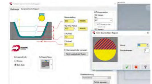
Sie können im Dialogfeld „Zusätzlicher Schlichtschnitt“ für einen Standard-Schrupp-Werkzeugweg jetzt unterschiedliche Vorschub- und Drehzahlwerte für den zusätzlichen Schlichtschnitt einstellen.
